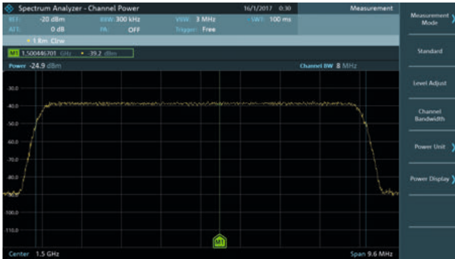
Опция R&S®FPC-K55: мощность в канале.
