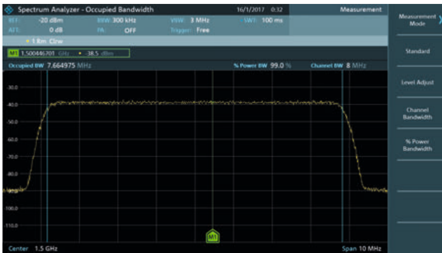
Опция R&S®FPC-K55: занимаемая полоса частот.
