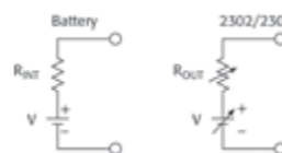
Упрощенная эквивалентная схема батареи и источника питания 2302/2306.
