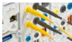
Каждый вход оборудован шунтами малого и большого тока
