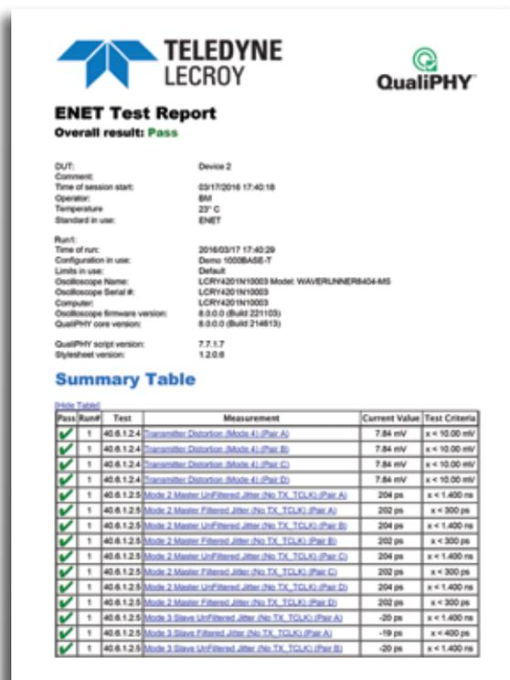
Отчеты испытаний содержат все параметры теста и их значения, специфичные пределы и скриншоты экрана. Отчеты теста на соответствие могут создаваться в виде файлов HTML, PDF или XML.
