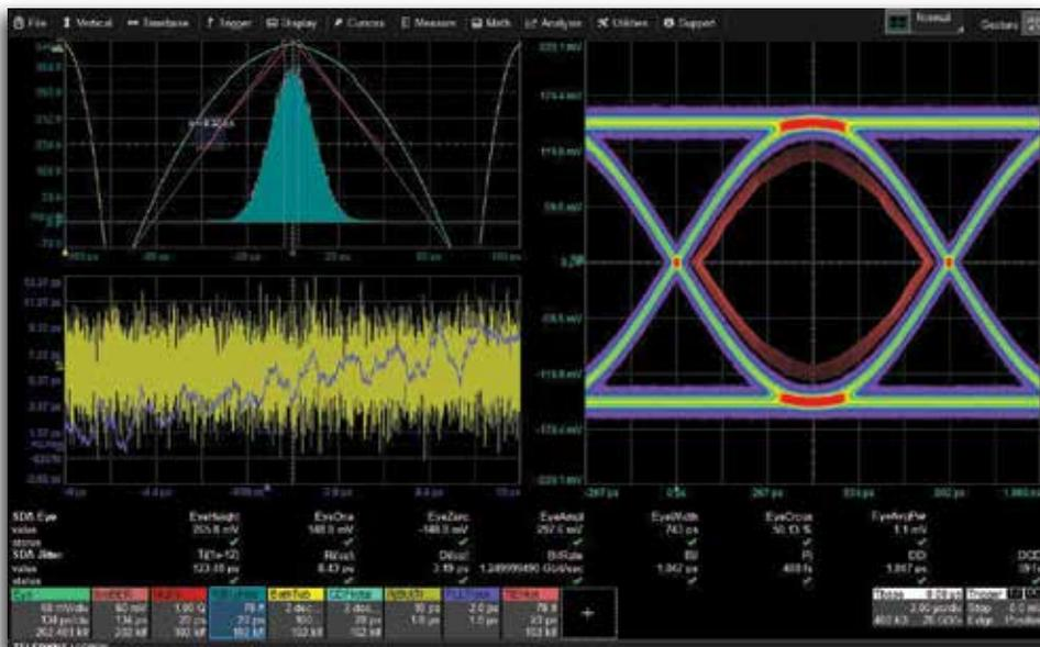
Прогрессивный метод разложения джиттера и инструменты анализа дают больше информации о корне проблем. Инструменты анализа: Tj (суммарный), DDj (джиттер данных), RjBUj (сум-
