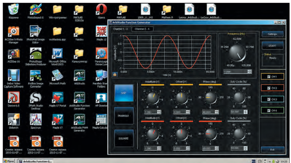
Рис. 12. Виртуальная передняя панель генератора в режиме DDS на фоне окна Windows XP компьютера
