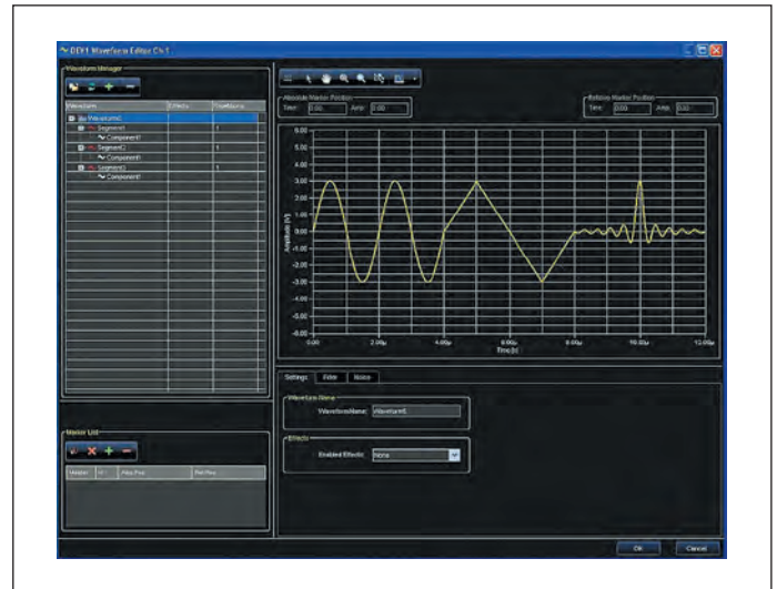
Рис. 17. Создание комбинированного сигнала из отрезков стандартных сигналов
