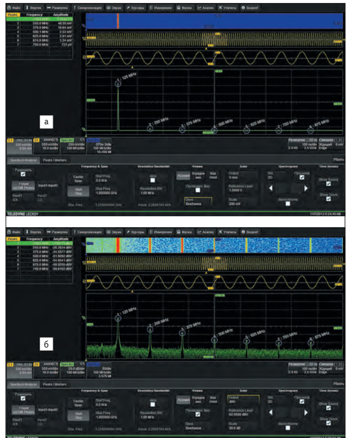
Рис. 21. Спектральный анализ синусоидального сигнала с частотой 125 МГц: а) при линейном масштабе спектра; б) при логарифмическом масштабе спектра
