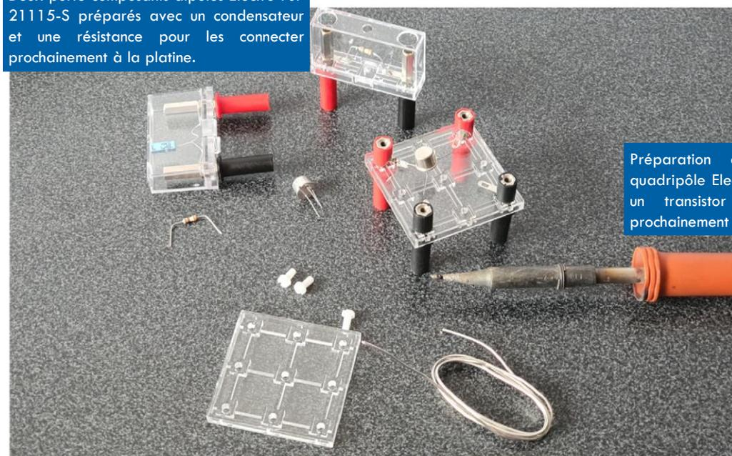
Préparation d'un porte-composant quadripôle Electro-PJP 21118-S avec un transistor pour le connecter prochainement à la platine.
