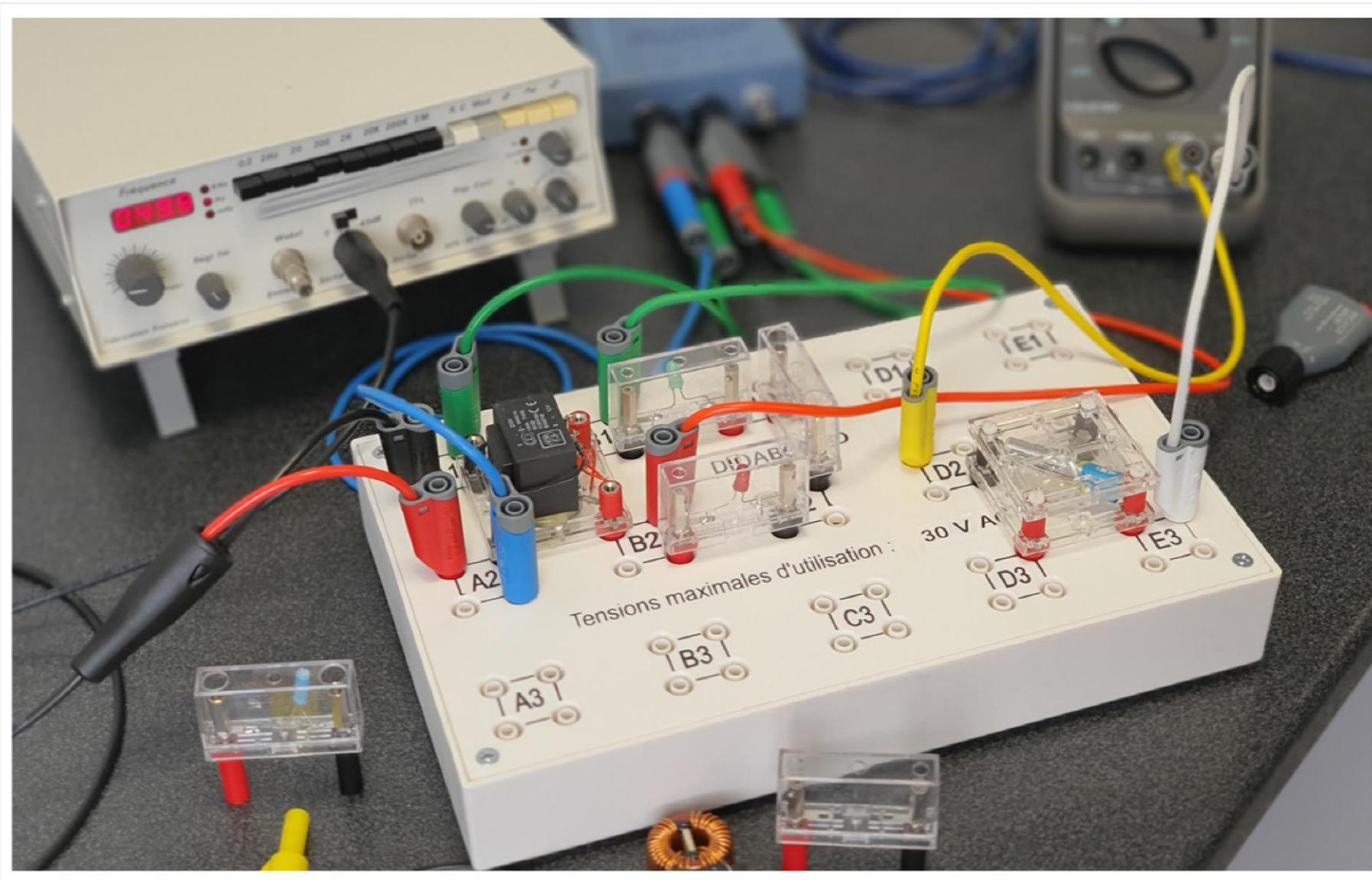
Description : platine d'électromanipulations avec 15 îlots au pas de 38 mm pour un total de 60 bornes banane 4 mm femelles à double puits.
