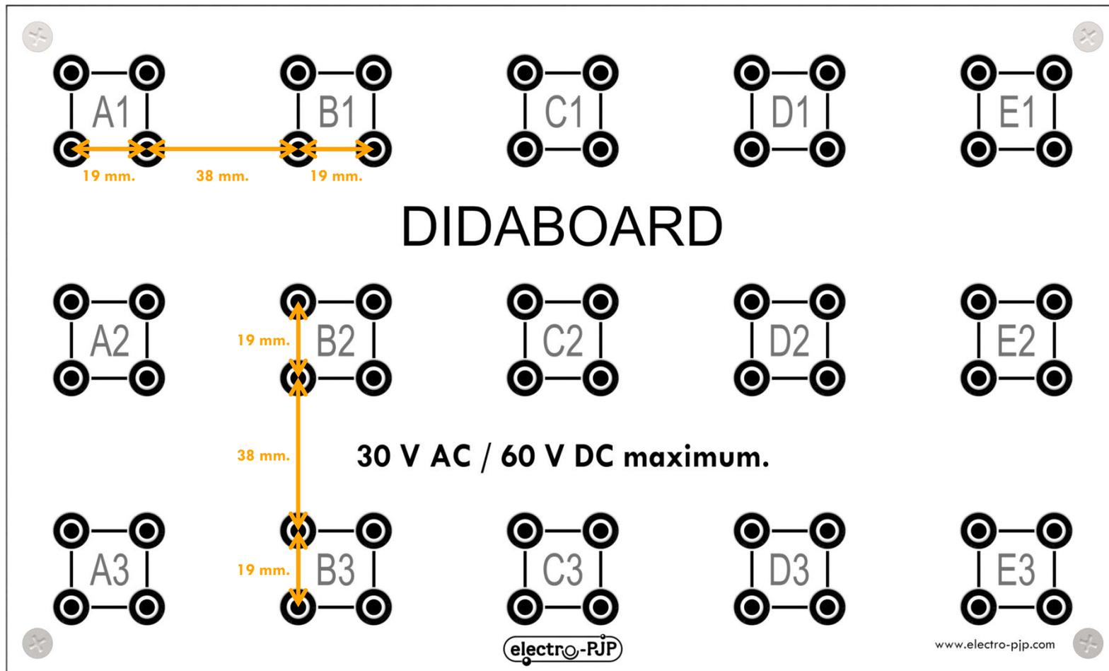
Description : platine d'électromanipulations avec 15 îlots au pas de 38 mm pour un total de 60 bornes banane 4 mm femelles à double puits.
