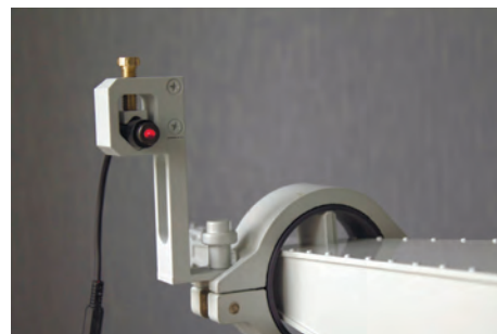
Пример установки кронштейна КЛ-1 на узел крепления антенны. (в сборе с лазерным маркером и измерительной антенной)
