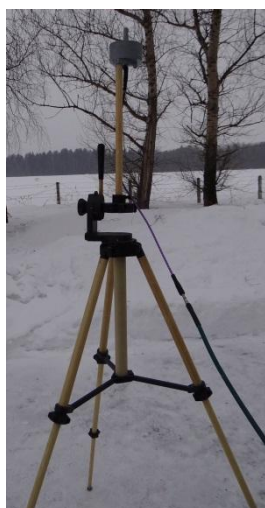
Фото 3. Антенна АС7.23 на диэлектрическом штативе
