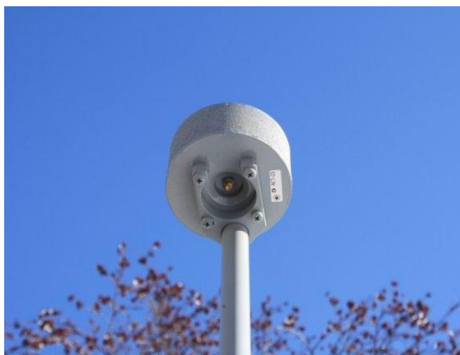
Фото 2. Антенна АС7.23, разъем SMA-типа
