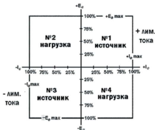
Вольт-амперная характеристика источников питания АК ИП-1106 и АК ИП-1106А
