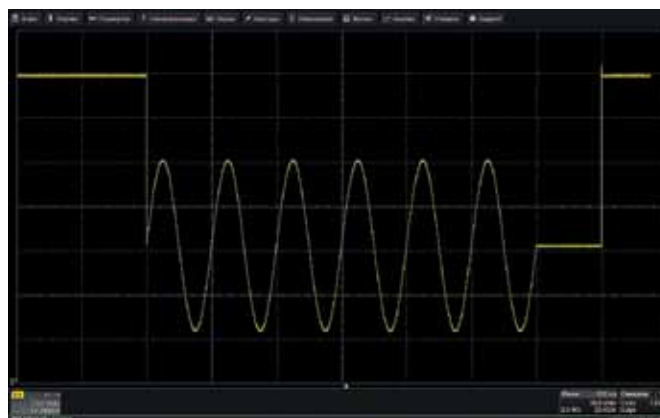
Осциллограмма сигнала произвольной формы на экране осциллографа LeCroy HDO6054
