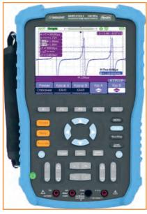
рений: напряжения между двумя курсорами; временного интервала между двумя курсорами и абсолютные измерения амплитуды и времени в точке пересечения курсора и осциллограммы.
