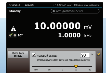
Синхронизация и регулировки фазы между двумя калибраторами для применения измерителя мощности.
