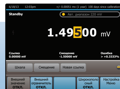
Клавиши OFFSET и SCALE позволяют легко компенсировать ошибки смещения нуля и шкалы и непосредственно отобразить ошибки линейности при любом масштабе.
