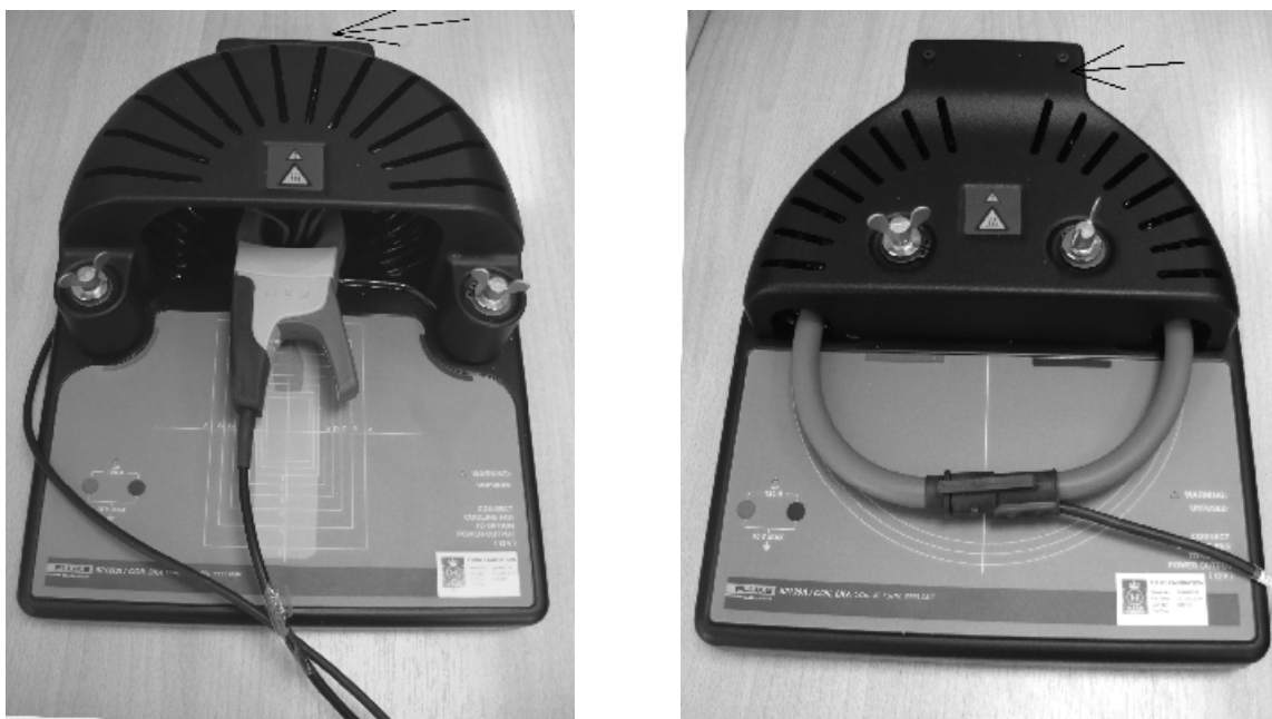
Рисунок 1 - Внешний вид катушек: слева - Fluke 52120A/COIL3KA в процессе калибровки токовых клещей; справа - Fluke 52120A/COIL6KA в процессе калибровки пояса Роговского. Стрелками показано место нанесения знаков утверждения типа.
