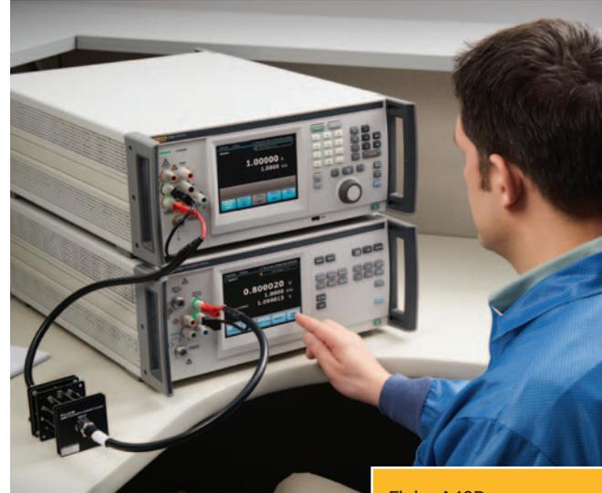
50 Ом доступна как опция для измерения эталонных выходов РЧ мощности. Опция «точно откалибрована» на конце кабеля метрологического класса прецизионного уровня/устойчивого по фазе. Рассчитывается измеренная мощность с нагрузкой 50 Ом.
