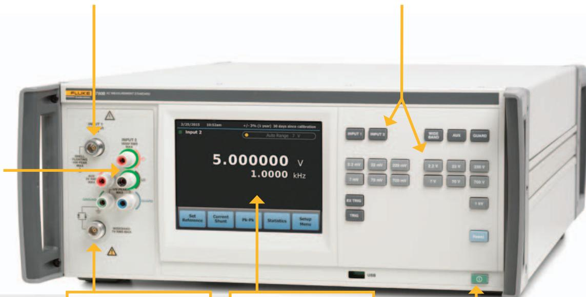
Дополнительные широкополосные опции расширяют диапазон частот до 30 МГц или 50 МГц для соответствия требованиям калибровки Fluke серий 5730A, 5700A и 5720A.
