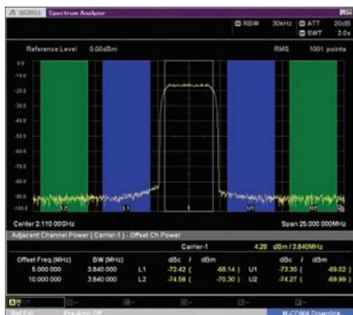
Коэффициент утечки по соседнему каналу W-CDMA (1 несущая) Шаблон формы волны (TestModel1, 64DPCH)
