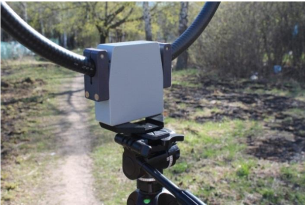
Фото 1. Вариант крепления антенны П6-119 на фотоштатив
