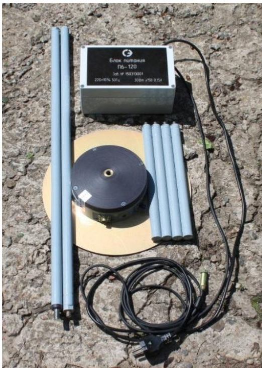
Фото 1. Антенна П6-120 в разобранном виде
