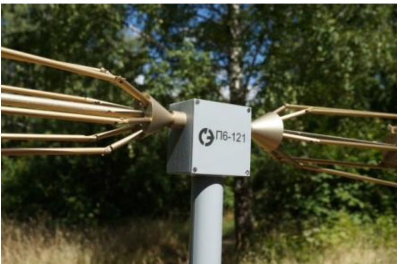
Фото 5. Антенна П6-121, центральная часть с вибраторами (спец. исполнение)
