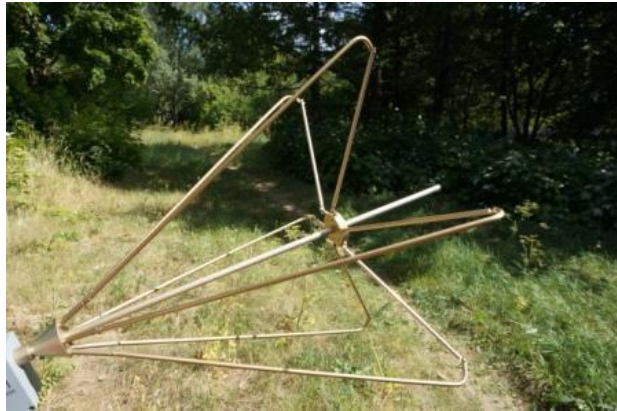
Фото 4. Антенна П6-121 на стадии сборки
