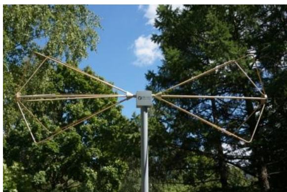
Фото 2. Антенна П6-121М1 спец. исполнение для работы в полевых условиях (рабочее состояние)
