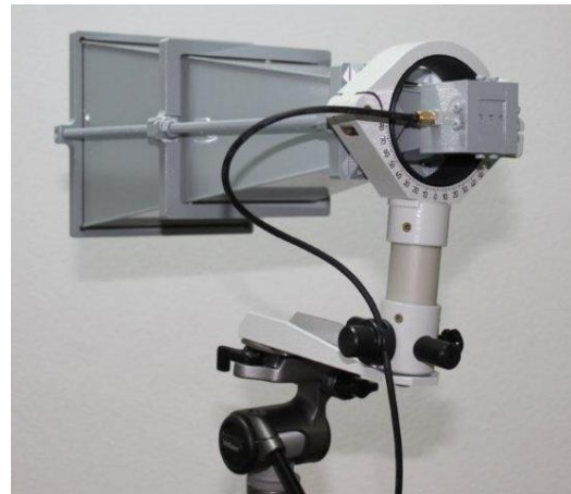
Фото 2. Антенна П6-124 узле крепления АК-02М
