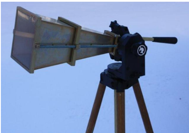
Фото 3. Антенна П6-124 на диэлектрическом штативе (ШАД-01), во влагозащитном исполнении
