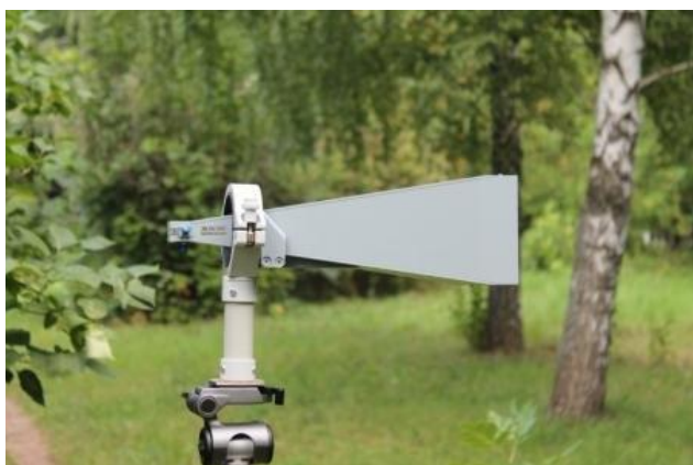
Фото 1. Антенна П6-129 на узле крепления АК-02
