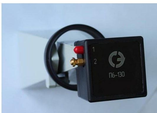
Фото 1. Антенна П6-130, фазовращатель
