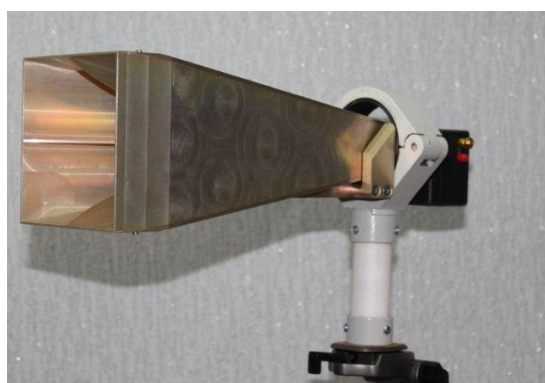
Фото 2. Антенна П6-130 на узле крепления АК-02М
