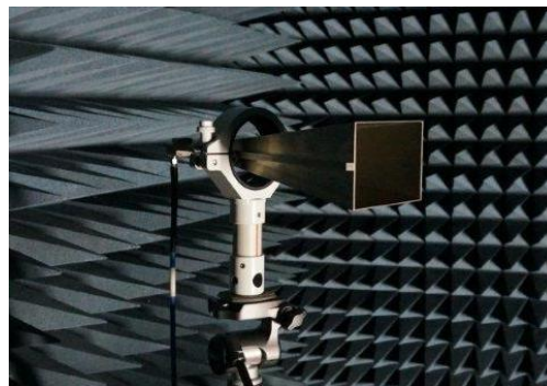
Фото 2. Антенна П6-131 на узле крепления АК-02М
